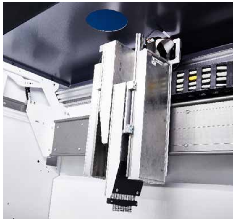
Figur 3. Eksempel på en laboratorierobot med hul i toppen beregnet til montering af udsug, som modsvarer det konkrete behov.
