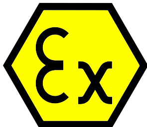
Figur 5 - Udstyr, der anvendes i EX-områder, skal være EX-mærket og beregnet til den pågældende zone.
