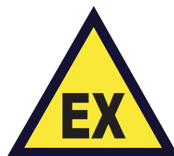
Figur 3: Indgange til eksplosionsfarlige områder, skal markeres med dette advarselsskilt
