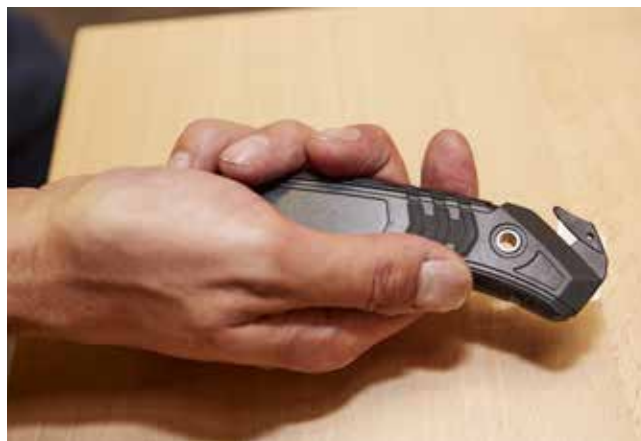
Eksempel på sikkerhedskniv med delvis skjult blad.
