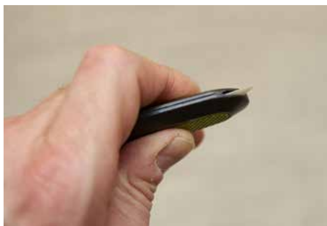
Eksempel på lille sikkerhedskniv til små simple skæreopgaver. Bladet trækkes automatisk tilbage efter brug. Den er forsynet med magnet, så den kan sidde på et fast sted ved arbejdspladsen eller på trucken. For ekstra sikring er bladet også her keramisk.
