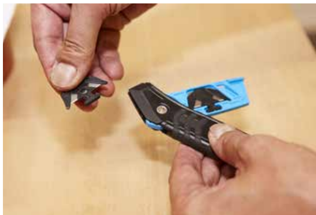
Eksempel på sikkerhedskniv med 2 skjulte blade. Her skiftes bladene uden risiko for stik- og skæreskader
