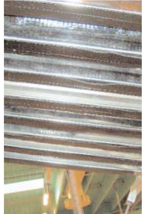
Undersiden af dåsevenderen med påklæbet antivibrationsfolie.
