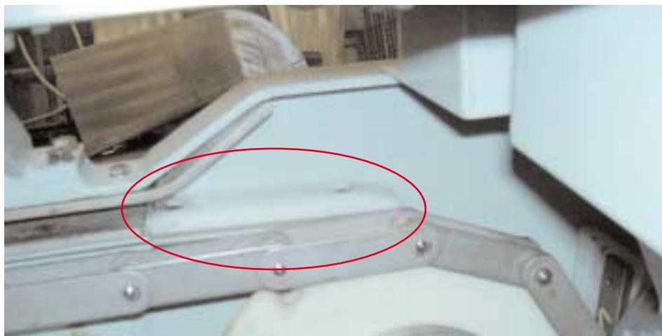
Polyethylenklods har erstattet metal og polyethylenhjul har erstattet metalhjul.
