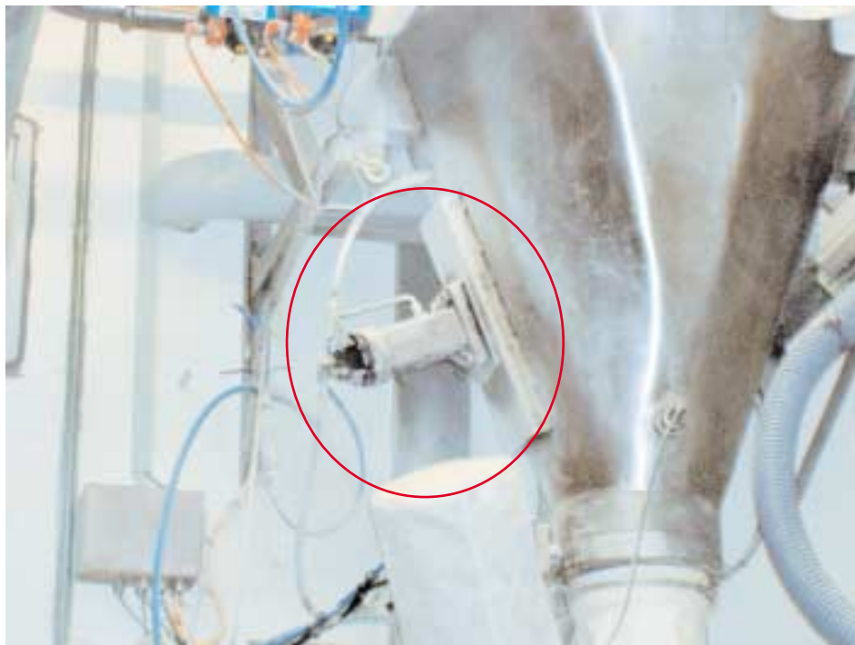
Vibrator med pålimet gummi.
