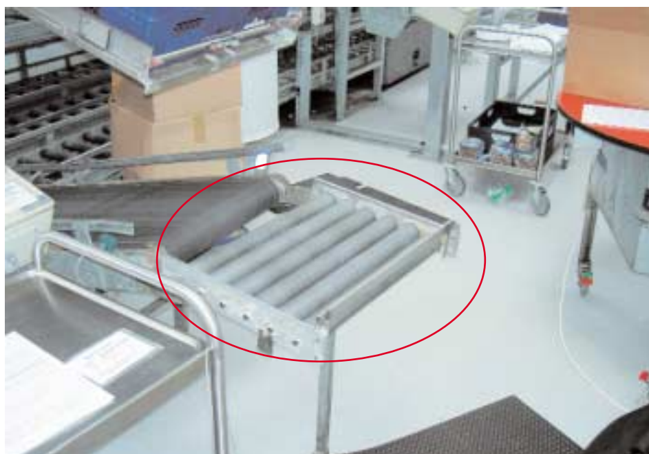
Pakkebord støjdæmpet med gummibelagte ruller.
