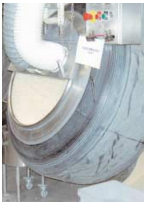
Drageringskedler beklædt med lyddødt materiale.
