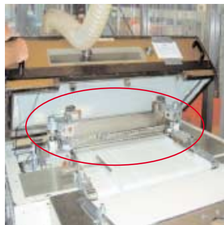
Indkapslingen lukket op, så man kan se den pneumatisk drevne kniv.
