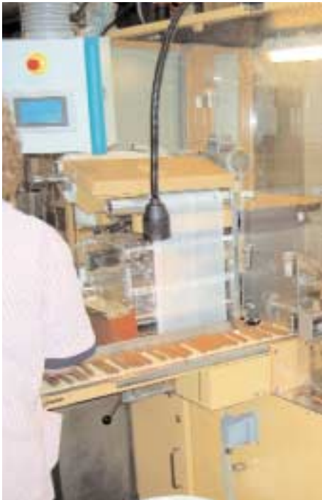
"Skræddersyede" indkapslinger af cigarillosmaskiner.
