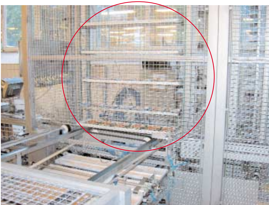
Elevatorsystem til transportbakker med frossen suppe.
