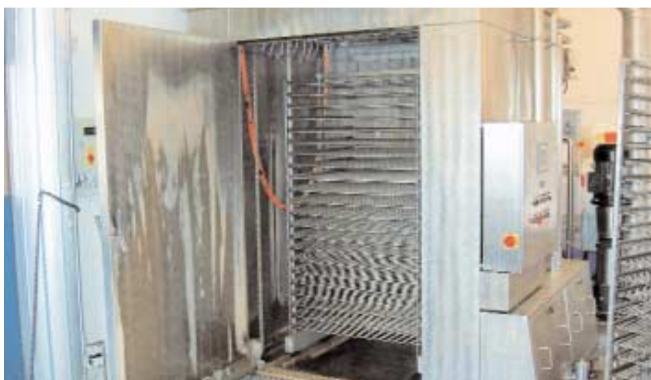
Højtryksrensning til rengøring af bure. Vaskemaskine med bur.
